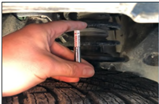
Usure des 4 pneus avec une jauge de profondeur.
